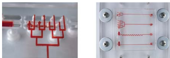
Bild 8 Interdigitale Einlassstruktur zur Erzeugung eines regelmäßigen Laminationsmusters.
