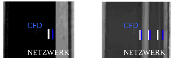
Bild 9 Laminationsmuster eines multilaminaren Flusses für ein Viskositätsverhältnis \beta \sim 27 .
