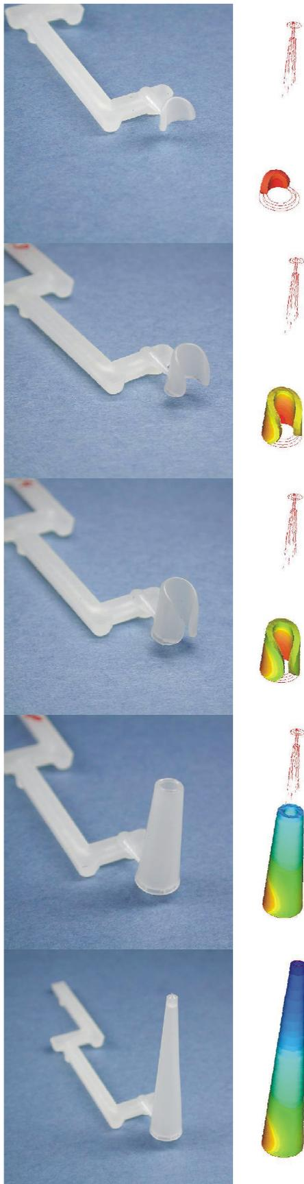
**Bild 5 Füllstudie und Füllsimulation (MoldFlow) im Vergleich.**
