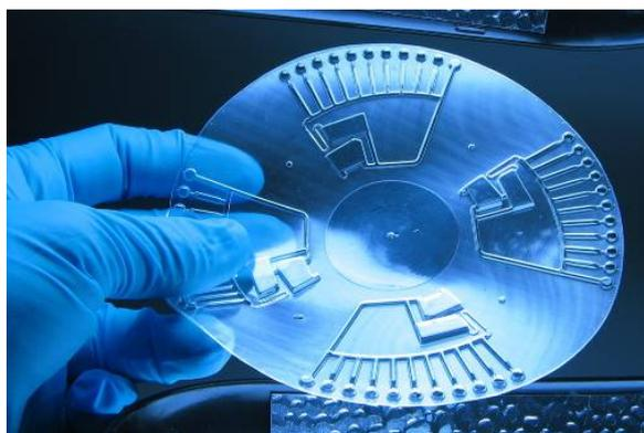
**Bild 4** Mikrofluidische Designs werden mit validierten Fertigungsprozessen, beispielsweise durch thermisches Umformen von Kunststofffolien, realisiert.
