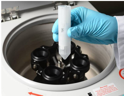
Bild 1 Prototyp des LabTubes zur DNA Extraktion in einer Standard-Laborzentrifuge (Z326K, Hermle Labortechnik); Bild von Bernd Müller
