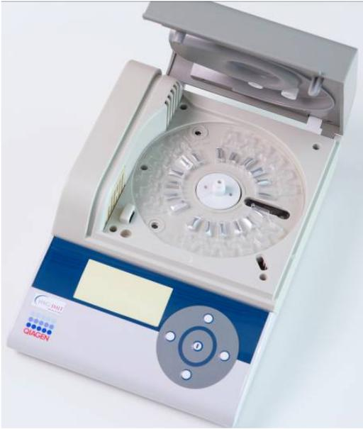
Abbildung 1: LabDisk Plattform für die Vor-Ort-Analyse.
