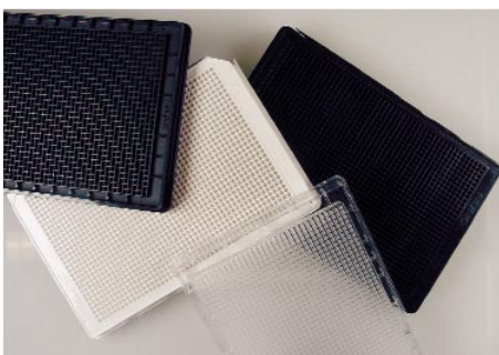
Abb. 3: Mikrotiterplatten mit 1.536 Reservoiren, wie sie im High-Throughput-Screening Verwendung finden.
