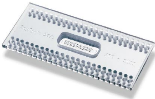
Abb. 1: Rechts: Biochip nach Aufbringen der Probenflüssigkeit unter dem Fluoreszenz-Reader. Links: TopSpot Druckkopf mit 96 Reservoiren.
