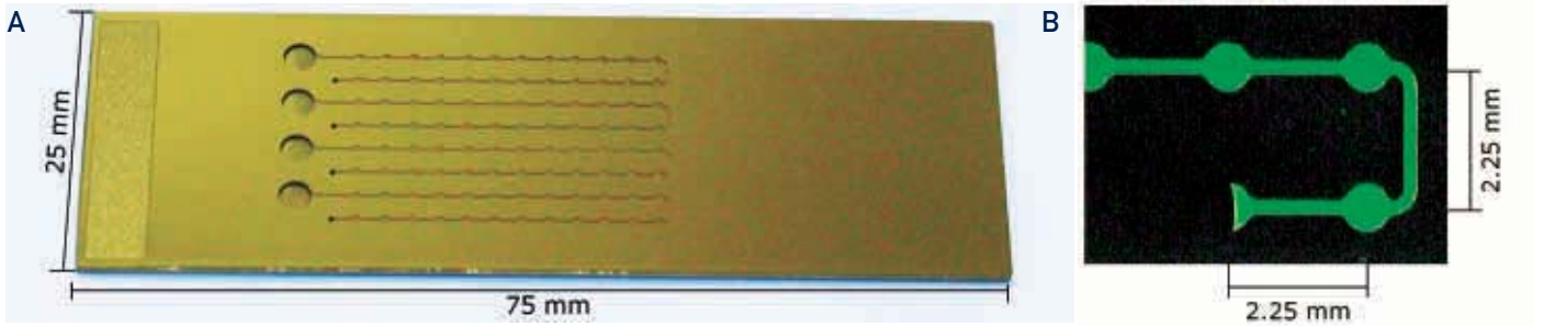
Abb. 5: NanoWellSlide. A. Foto eines NanoWellSlides. B. Befüllvorgang im NanoWellSlide. Zur Visualisierung wurde der Flüssigkeit ein Fluoreszenzfarbstoff beigemischt.
