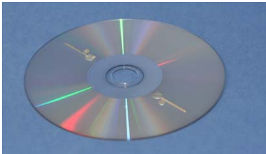
Abb. 1 Bio-DVD zur Hämatokritbestimmung aus 2 Standard DVD Polycarbonat-Halbscheiben gebondet
