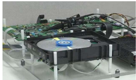
Abb. 3 Versuchsstand DVD Player mit Rechner
