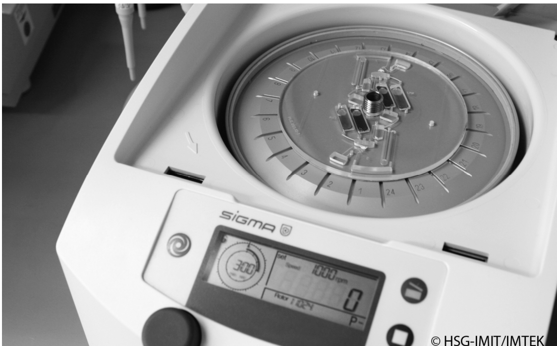
Abb. 1: Mikrofluidische Polymerdisk zur Automatisierung einer DNA-Aufreinigung aus lysiertem Blut. Die für die Aufreinigung benötigten Waschpuffer sind auf der Disk vorgelagert. Der Betrieb erfolgt in einer Standard-Laborzentrifuge. Die automatische Flüssigkeitssteuerung sorgt dabei für ein Abtrennen der aufgereinigten DNA von weiteren Probenbestandteilen und Waschpuffern.
