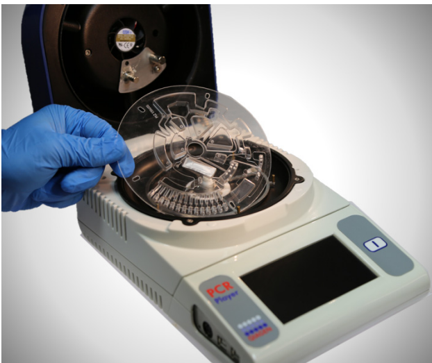
Abbildung 1: LabDisk Player für die automatisierte Prozessierung der LabDisks
