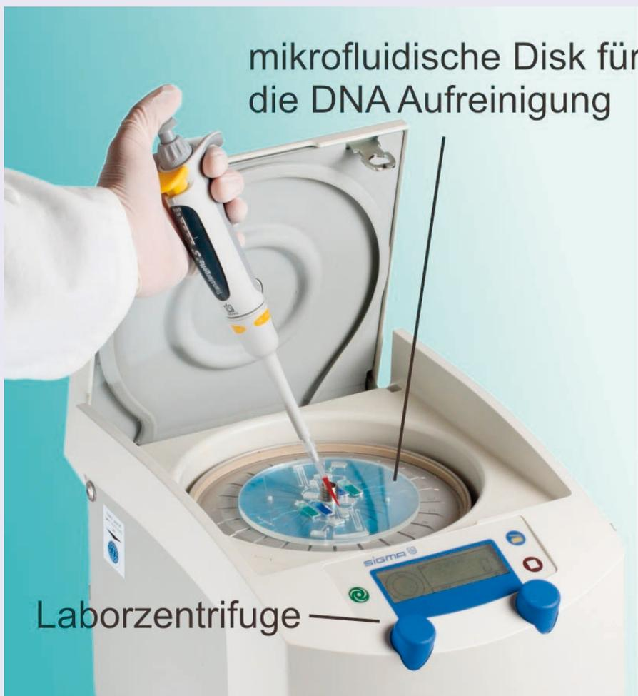
**Bild 3:** Mikrofluidischer Testträger für die automatische DNA-Aufreinigung in einer Standard-Laborzentrifuge.
