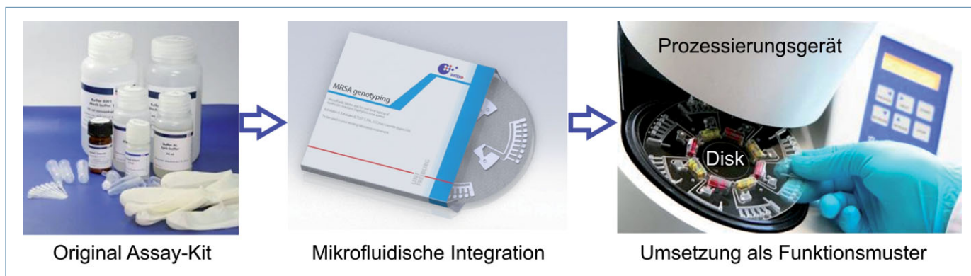
▲ Abb. 1: Lab-on-a-chip -Systeme ermöglichen die Automatisierung von biochemischen Assays in kompakten Geräten. Somit kann ein Assay durch mikrofluidische Integration „funktional verpackt“ werden. Das heißt, die Flüssigkeitshandhabung kann komplett in der Verpackung erfolgen und durch ein Prozessierungsgerät automatisiert werden. Als Prozessierungsgerät dient ein modifizierter zentrifugaler Thermocycler mit verbesserter Motorsteuerung (Rotor-Gene 2000, Qiagen).
