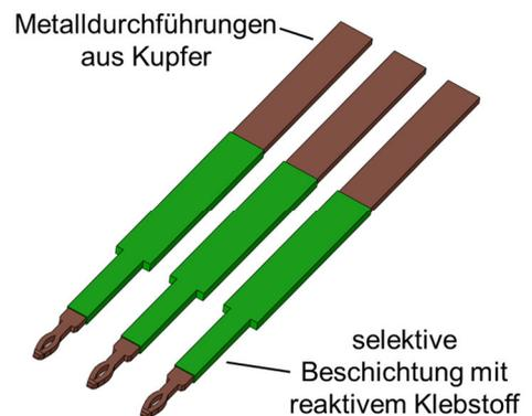
einen XYZ-Roboter über den Durchführungen positioniert werden kann. Bei der Prozessentwicklung ist neben der Schichthomogenität auch die Abgrenzung zu den elektrischen Kontaktflächen entscheidend. Das Beschichtungsbild soll daher über geeignete Messverfahren und insbesondere der Schlibfbildpräparationen analysiert werden. Über Variationen, z. B. in der Klebstoffschichtdicke, soll zudem ein Optimum bei der Dichtigkeit bestimmt werden, welche über die Messung der Leckrate quantifiziert wird.
