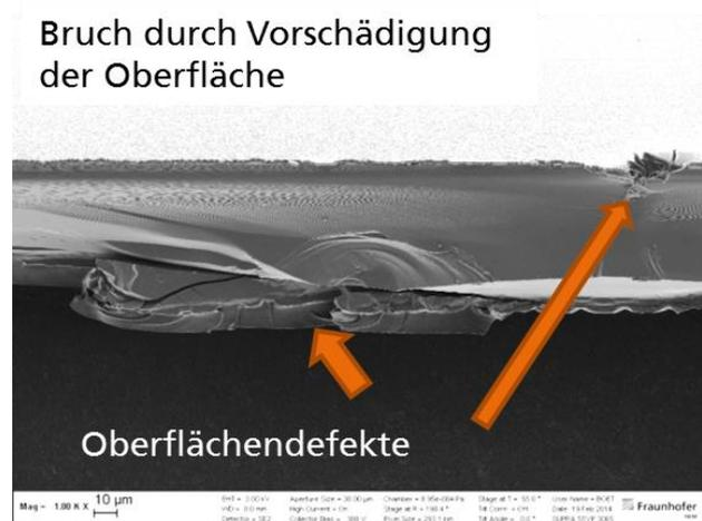
Abbildung 10: Fraktografische Analyse der Oberfläche eines IGBTs mit Bruchursprung an einem Oberflächendefekt
