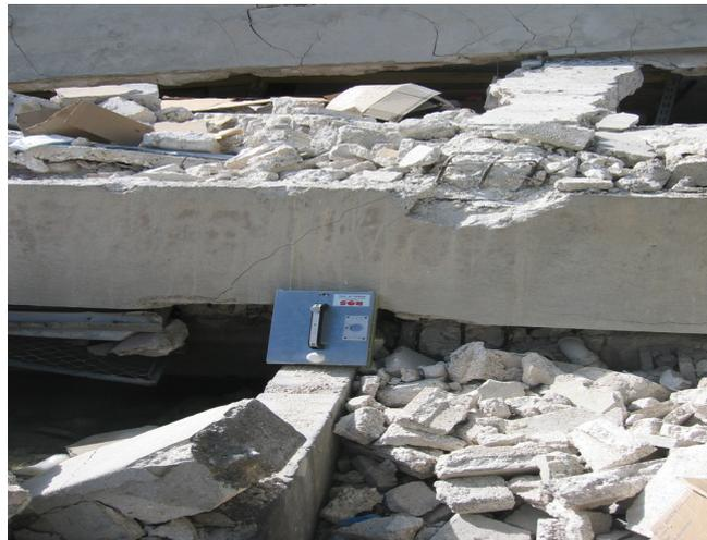
Das Bio-Radargerät im Einsatz
