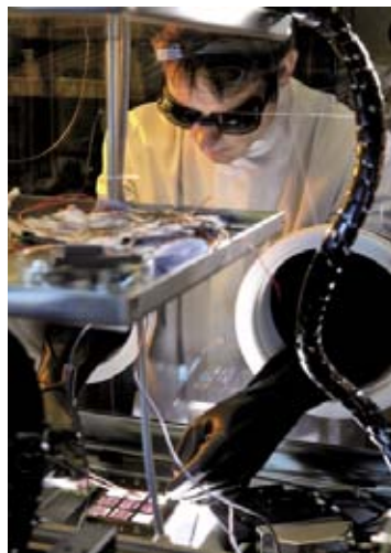
Arbeit in der Glovebox, einem luftdichten Glaskasten, der die Solarzellen (rosa Quadrate) vor Umwelteinflüssen schützt.
